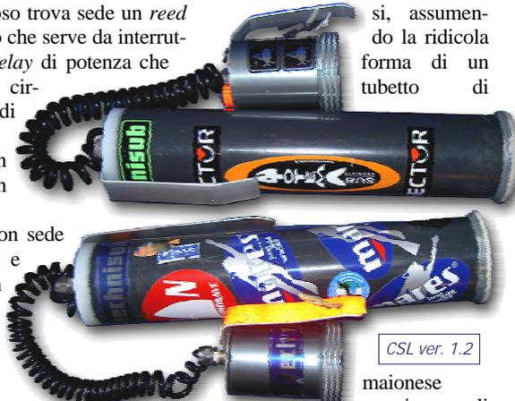
pacco batterie per la versione "CSL 1.3 Millennium" è stato realizzato, grazie ad amici tornitori, interamente in alluminio anodizzato ed è stato per la prima volta provato al mare quest'estate in Sardegna.
